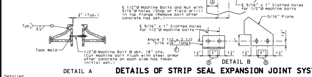
DETAIL A DETAILS OF STRIP SEAL EXPANSION JOINT SYSTEM AT INTERMEDIATE BENT NO.
