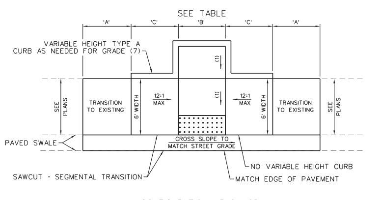
CONFIGURATION MB-2 MOD. TYPE C CURB RAMP SINGLE PARALLEL AT MIDBLOCK CROSSING
