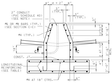
PART ELEVATION (TYPE C CONCRETE TRAFFIC BARRIER)
