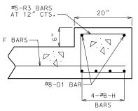
DOWNSTREAM HEADWALL REINFORCEMENT
