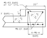
DOWNSTREAM HEADWALL REINFORCEMENT
