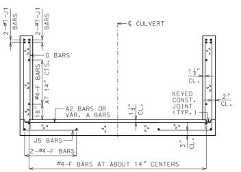
DOWNSTREAM WINGS REINFORCEMENT
