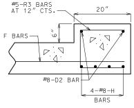
DOWNSTREAM HEADWALL REINFORCEMENT
