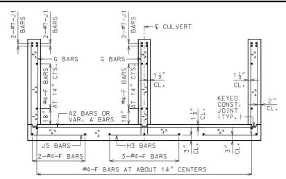
DOWNSTREAM WINGS REINFORCEMENT
