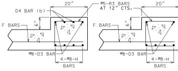
DOWNSTREAM HEADWALL DOWNSTREAM HEADWALL REINFORCEMENT NEAR INTERIOR WALL
