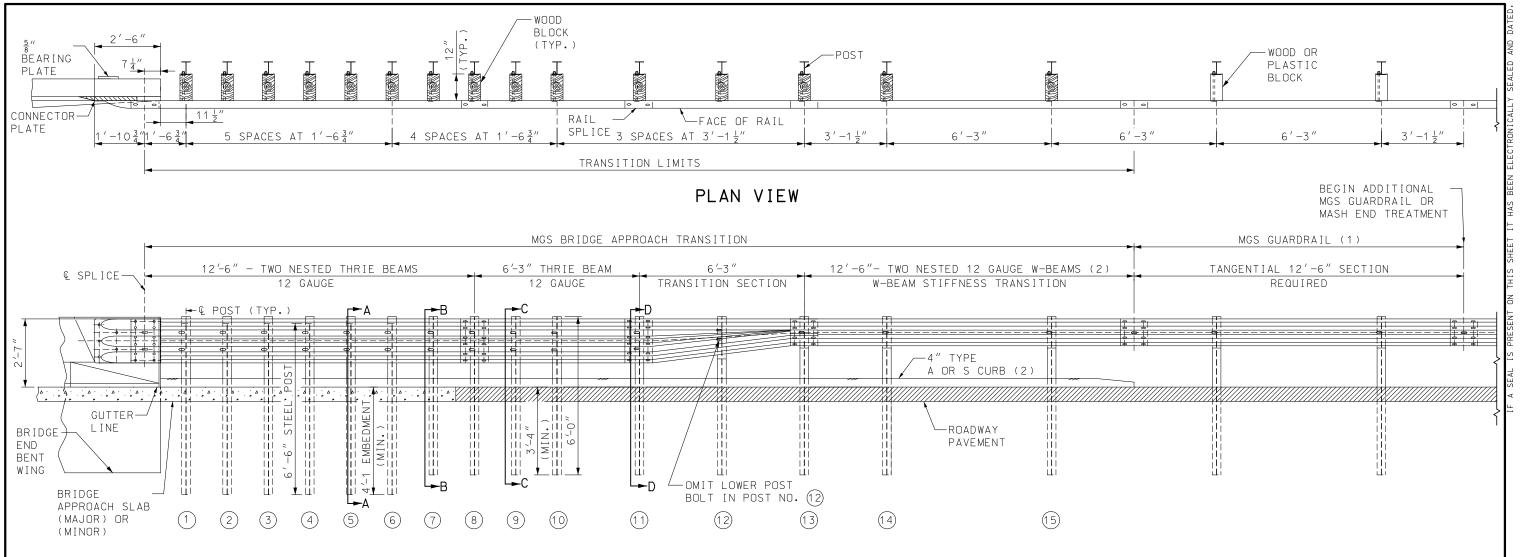
MGS GUARDRAIL SHALL BE TANGENTIAL WITH BRIDGE APPROACH TRANSITION FOR 12'-6" BEYOND THE TWO NESTED W-BEAM STIFFNESS TRANSITION AND 25'-0" BEYOND THRIE BEAM TRANSITION SECTION.
