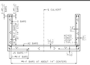
DOWNSTREAM WINGS REINFORCEMENT
