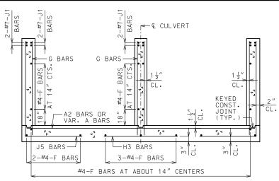
DOWNSTREAM WINGS REINFORCEMENT
