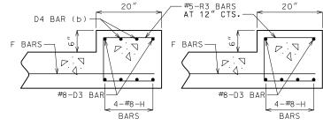
DOWNSTREAM HEADWALL DOWNSTREAM HEADWALL REINFORCEMENT NEAR INTERIOR WALL
