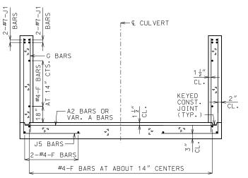
DOWNSTREAM WINGS REINFORCEMENT
