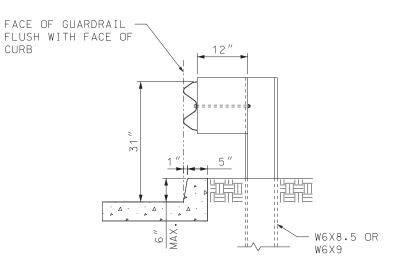
MGS GUARDRAIL AT CURB
