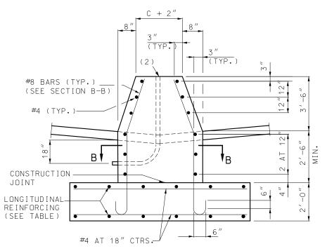
PART ELEVATION (TYPE C CONCRETE TRAFFIC BARRIER)
