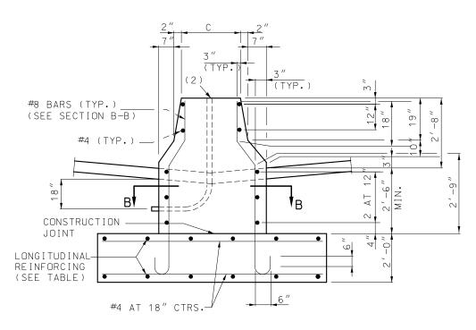
PART ELEVATION (TYPE A CONCRETE TRAFFIC BARRIER)
