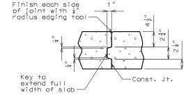
SLAB CONSTRUCTION JOINT
