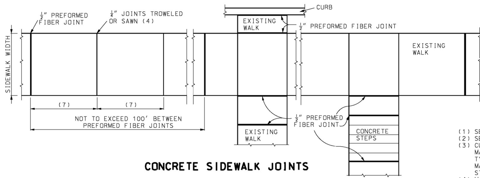
**CONCRETE SIDEWALK JOINTS**
